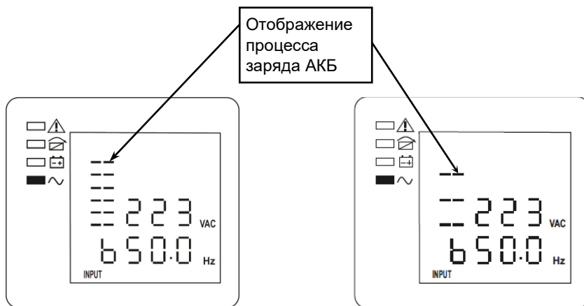
Рисунок 17 — ЖК-дисплей, форсированный (ускоренный) заряд АКБ
